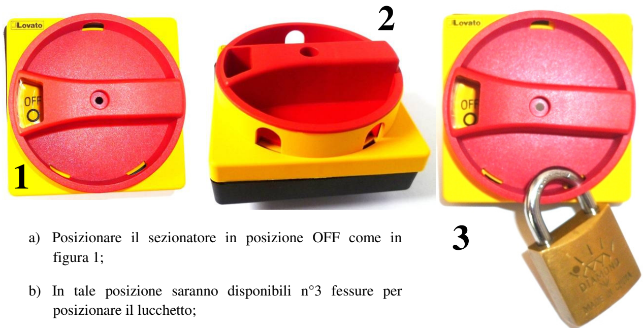
Figura 2.9: Sezionatore esterno al quadro lucchatabile (<100 A)
