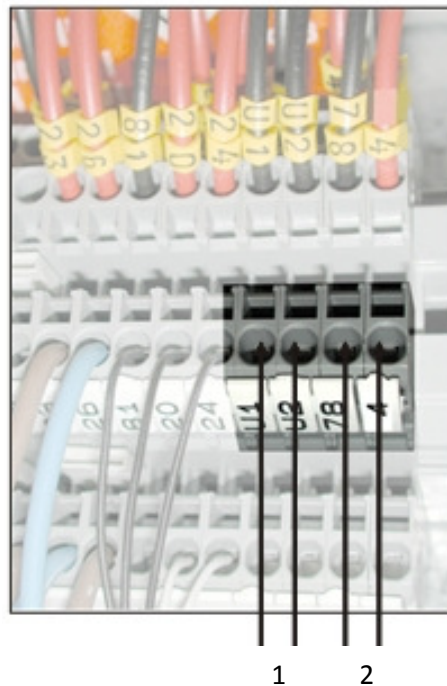
Figura 3.12: Esempio morsettiera utente
